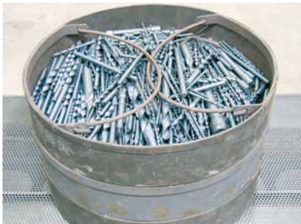
Bläuen von Bohrern mit Wasserdampf in einem Ofen der Baureihe NRA siehe Seite 12
