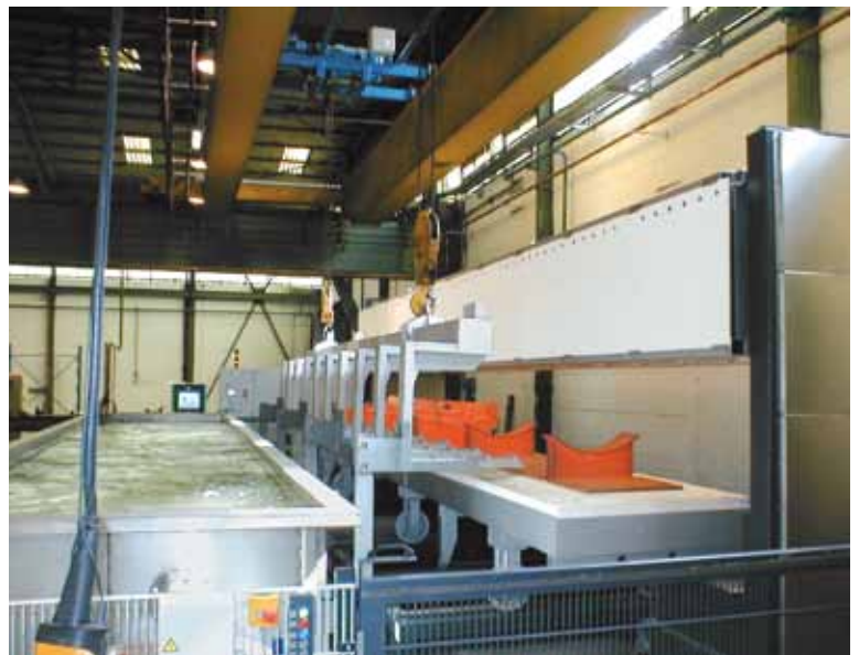
Manuelle Vergüteanlage zum Härten von Stahlstangen siehe Seite 62/63
