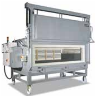
Glühofen mit elektrohydraulischer Hubtür und fahrbarem Untergestell zum Vorwärmen großer Blechteile in der Automobilindustrie siehe Seite 44
