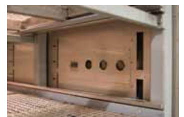
Durchführungen für Vakuum- und Messanschlüsse an einem Umluft-Kammerofen
