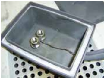
Hartlöten im Begasungskasten
