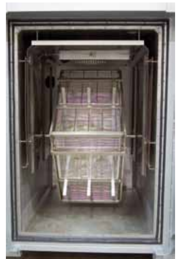
Silikon-Temperöfen mit dicht geschweißtem Innenkasten und Drehgestell für die Charge
