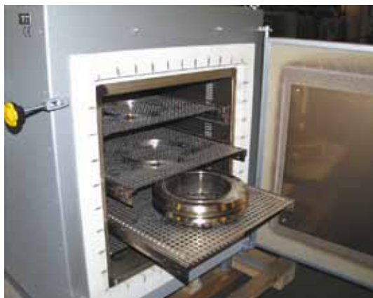
Ofenraum mit Chargierrosten in einem Umluftofen. Die Einschübe sind einzeln auf Teleskopschienen geführt und können so individuell herausgezogen werden.
