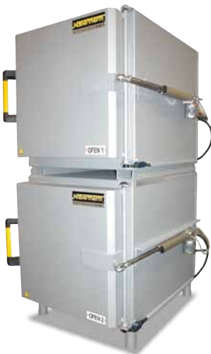
Doppelkammerofensystem bestehend aus zwei Luftumwälzöfen N 250/65 HA mit pneumatischer Öffnung der Schwenktüren zum Kühlen und vereinfachten Chargieren der Öfen
